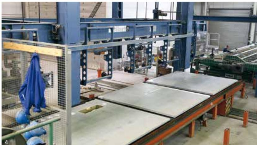
4 Fertig! Eine Doppelwand verlässt die Wendestation und steht für die Einlagerung in der Härtekammer bereit.
